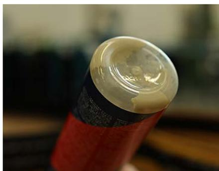
シーラント液の固体粒子は分離してボトルの底に付着する傾向があります。
