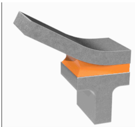
図 6 3m.com から取得した剥離ストレスの図
