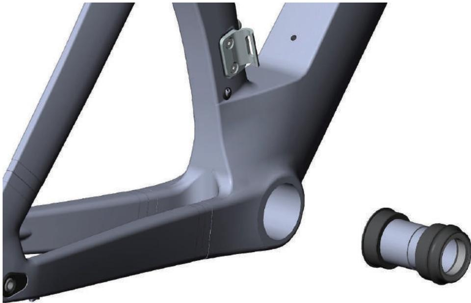
フレームのボトムブラケット内側とボトムブラケットカップをイソプロピルアルコールで拭いてきれいにします。
